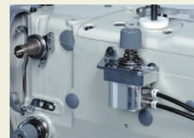
MP-G10-AT エア式2段テンション装置
