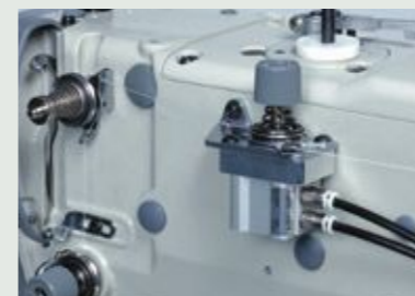
MP-G40-AT エア式2段テンション装置
