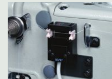
MP-G40-TS 上糸切れ検知装置
