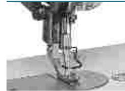
使用上下推布牙夹住难以推动的材料，进行切实的推布。
