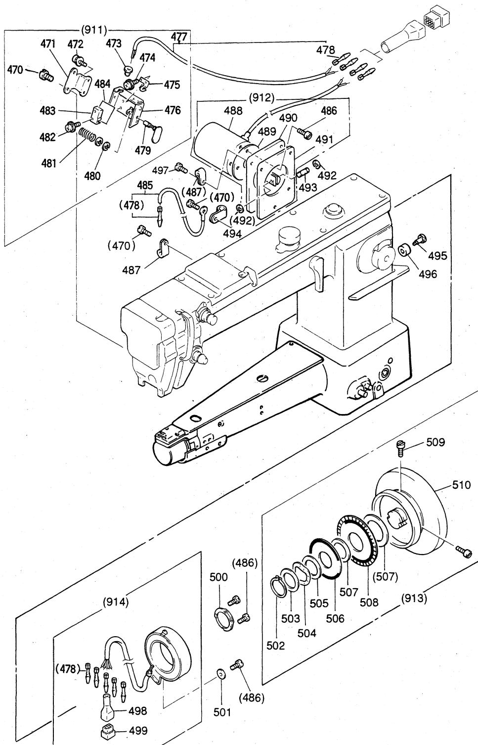
[J] タッチバック機構および検出器機構
