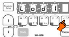
\* [ D ] キーを押し続けると [ LOAD 1 ] が点滅し、読み出し処理を行なう。
