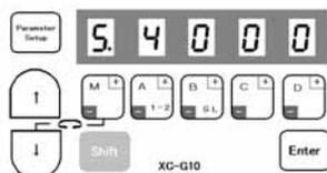
\* 例えば、最高速度設定が4000回転の場合、ペダルをいっぱい踏み込んだ時の速度は、上図のように [ S . 4 0 0 0 ] を表示します。
