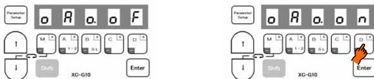
\* [D] キーを押している間、選択した出力端子に出力がでます。
