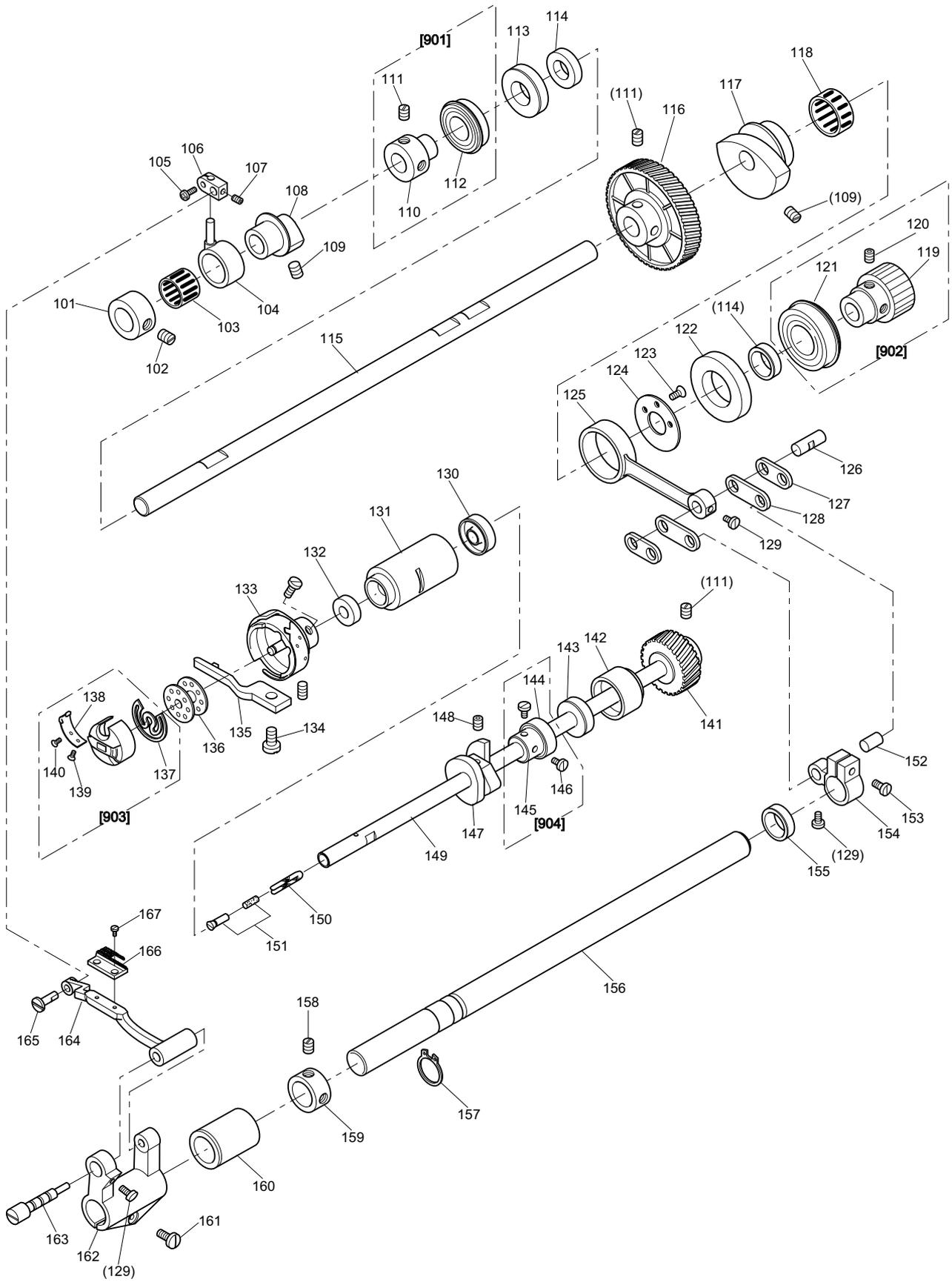
C 縫い機構(Ⅱ)・水平送り機構・上下送り機構
